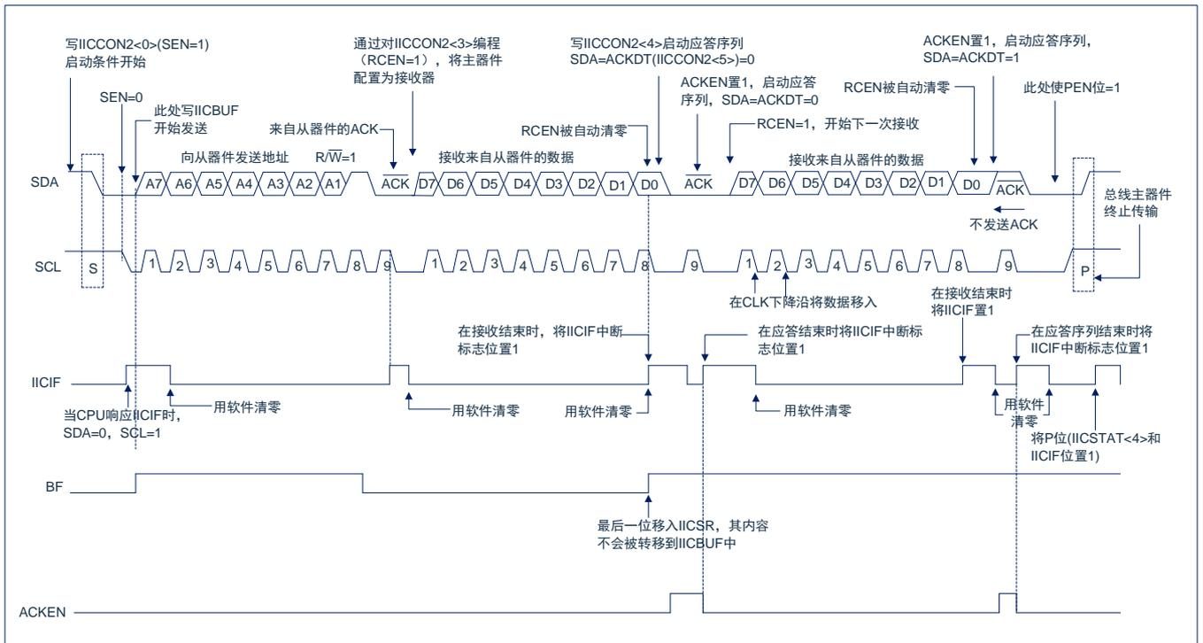
图20-6: I<sup>2</sup>C™主控模式接收时序
