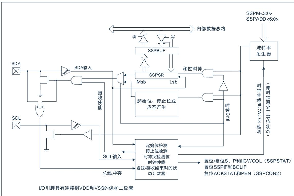
图20-2: IIC框图 (I<sup>2</sup>C™主控模式)
